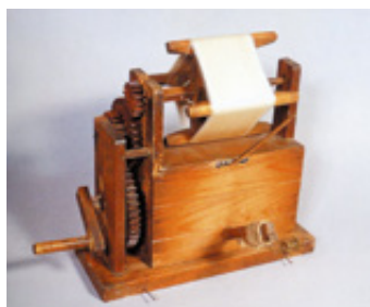
ちい き きかい て まわ まゆ 小さな木の器械を手で回して繭から生糸を作ります。
