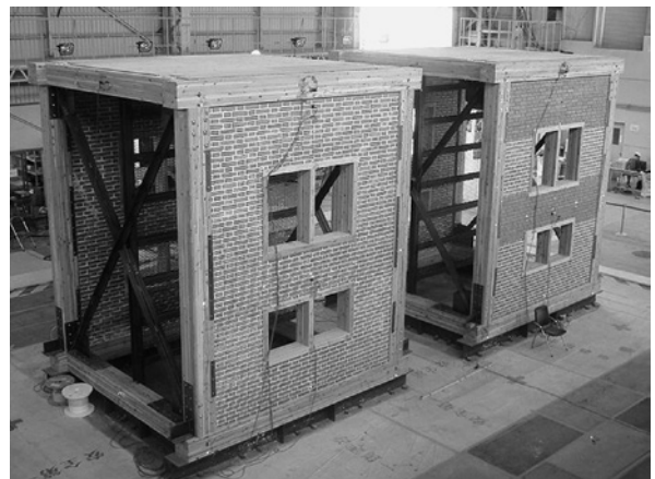
【写真2】 振動台実験（画像提供 富岡市・富岡製糸場）
