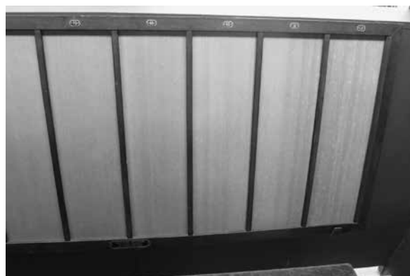
【セリプレーン検査】 (上) 大中類標準写真 (下左・右) 糸条斑標準写真 群馬県蚕糸技術センターより
